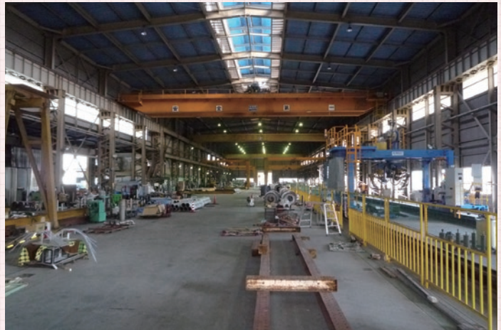
▲関江南線を東に2km程入った山の中に突然大きな工場が現れました。広大な敷地の中に4つの工場があって、写真の第1工場はサッカーコート2面程の面積があり、そこで橋や上下水道場内の設備機器を組み立てています。100mを超える超大型製品も製作できるのがこの会社の強みです。
