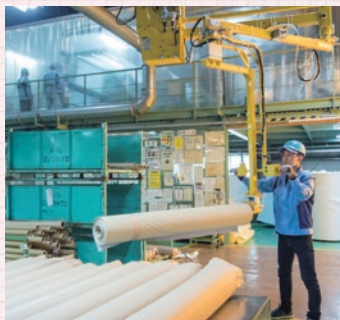
▲重量がある表皮材はハンドリフトを活用して、スムーズに接着機械へ供給します
