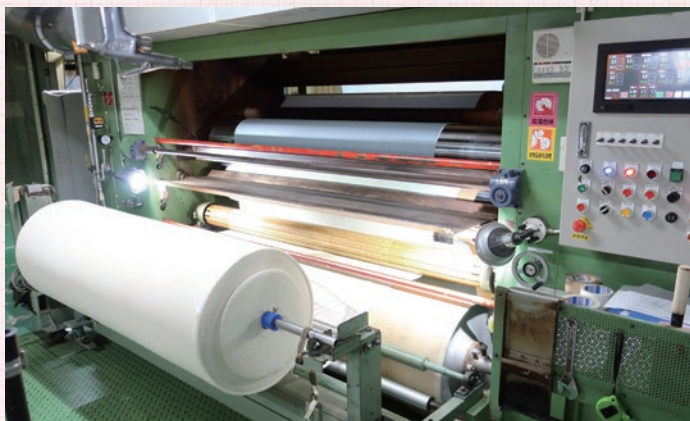
▲自動車のシートに居住性という快適機能を付加するため、シート表皮材にウレタンを接着させます
