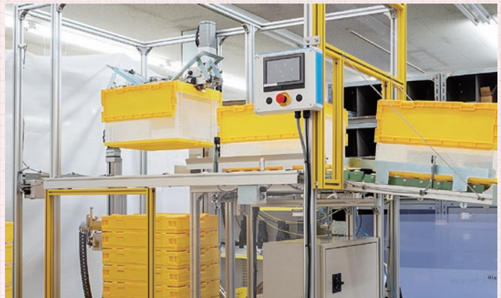
▲折りたたみコンテナ自動組立機。崩して積まれた状態の折りたたみコンテナを自動で組立てる機械です。
